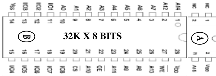
Figura 8.26 - Compatibilidade de funções quase total entre os chips de 32K e 64K.
