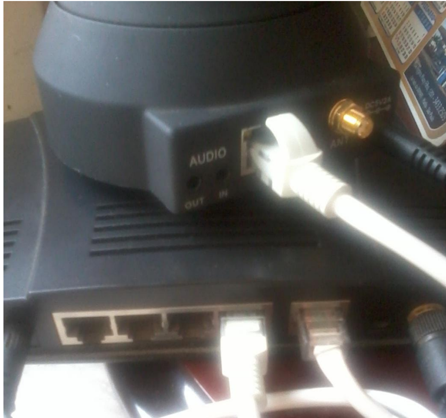
Figura 19 - Câmera IP (FOSCAM) conectada com o Roteador
