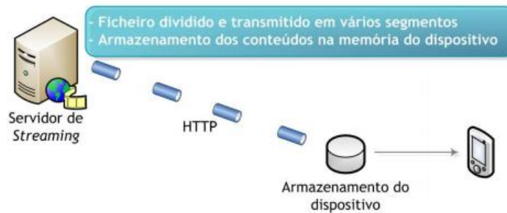
Figura 3 Ligação entre servidor e terminal, utilizando um protocolo do tipo download progressivo (sobre HTTP)
