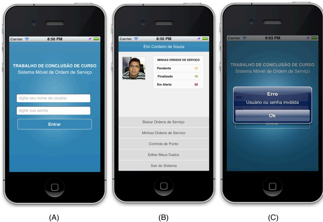
Figura 46- (A) Tela de Login; (B) Em caso de sucesso tela principal da aplicação; (C) Em caso da falha será exibida uma mensagem de erro.
