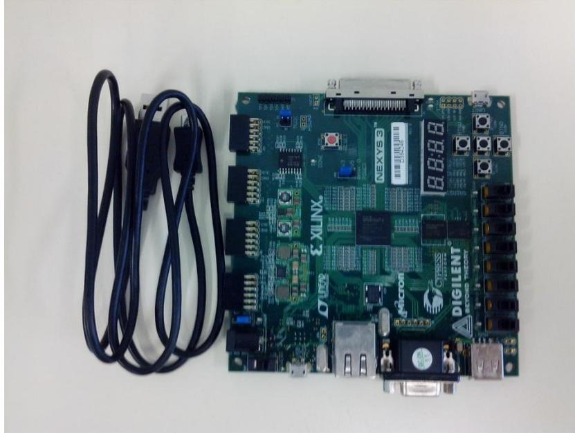
Figura 3 - Dispositivo Xilinx Spartan-6 LX16 FPGA e USB
