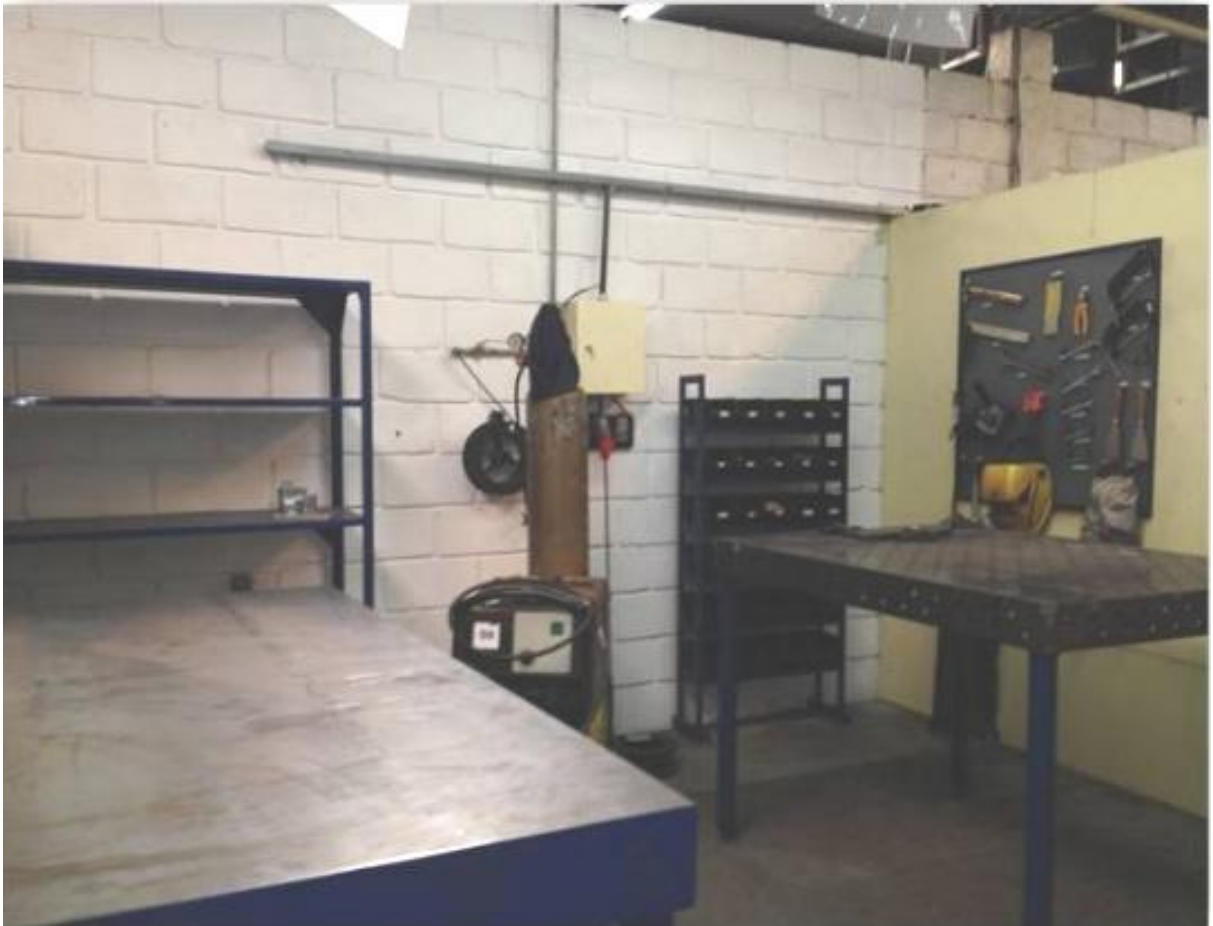
Figura 13 – Cabine de Solda Remodelada (5s) com apresentação da mesa 1 e mesa 2
