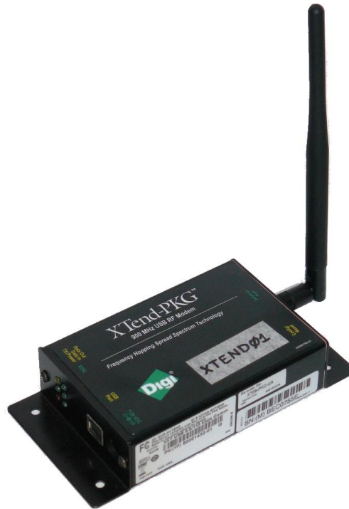
Figura 8 - Rádio modem Digi XTend-PKG 900 MHz.
