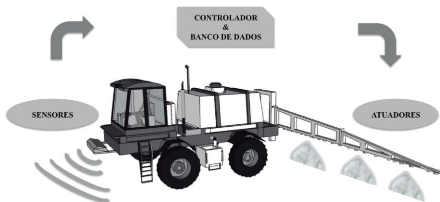
Figura 1 - Sistema de sensoriamento e aplicação de insumos.
