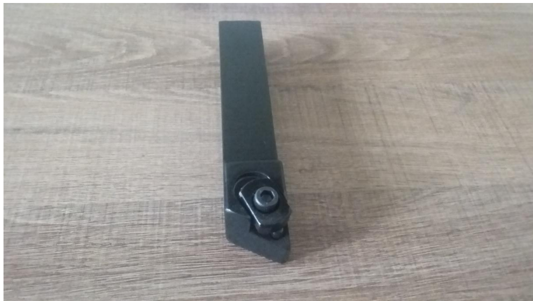
Figura 9 - Produto Suporte Externo – Triangular Furada de 22
