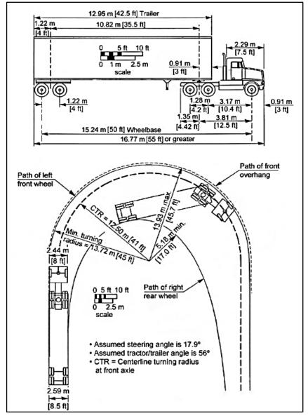
Figura 13- Dimensões do veículo da simulação.
