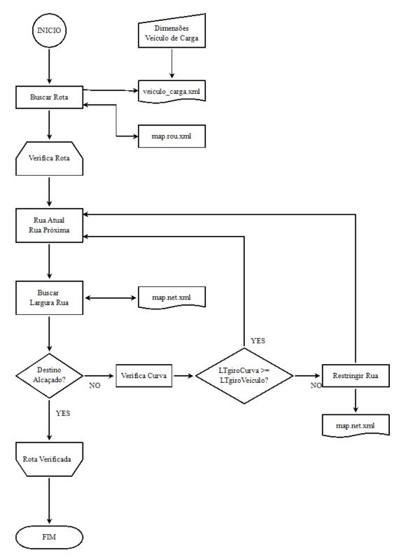
Figura 11- Fluxograma do algoritmo de restrição de giro.
