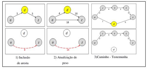
**Figura 5-** Antes e depois da remoção do nó d em três cenários.
