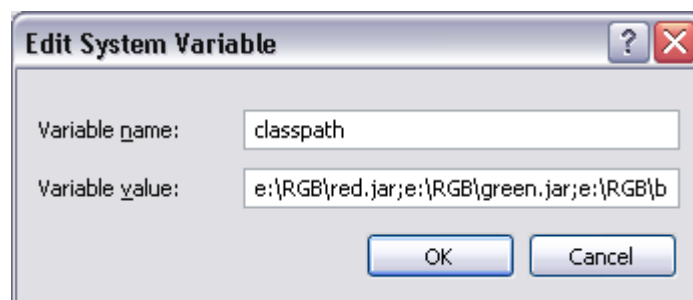
Figura 19: Configurando os arquivos que compõem a API RGB Java na variável de ambiente classpath .
