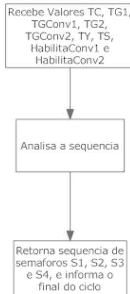
No módulo de retorno da sequência, é retornado um sinal lógico indicando quais lâmpadas estão acesas, assim gerando o controle dinâmico; adaptativo e em tempo real do micro-controlador.
