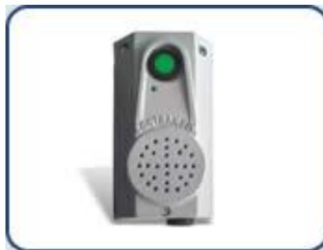
O acionamento deste detector é ativado pelo usuário através do pressionamento de um botão que informa ao controlador de trafego uma solicitação de direito de passagem (CONTRANSIN, 2011). A solicitação é atendida em momentos pré-definidos do ciclo no plano em execução, evitando com isto uma perda de sincronismo entre as interseções de uma rede semafórica coordenada.
