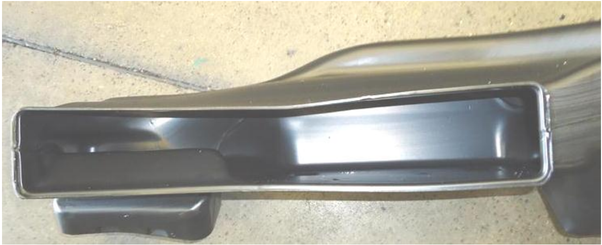
Figura 16 – Bocal Maior do Duto de Ar empenado
