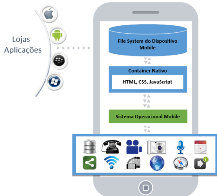
Figura 2 - Arquitetura do funcionamento de uma aplicação híbrida
