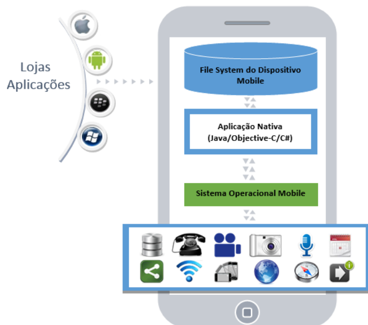
Figura 1 - Arquitetura do funcionamento de uma aplicação nativa
